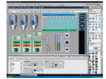
WinCC HMI Projelendirme
